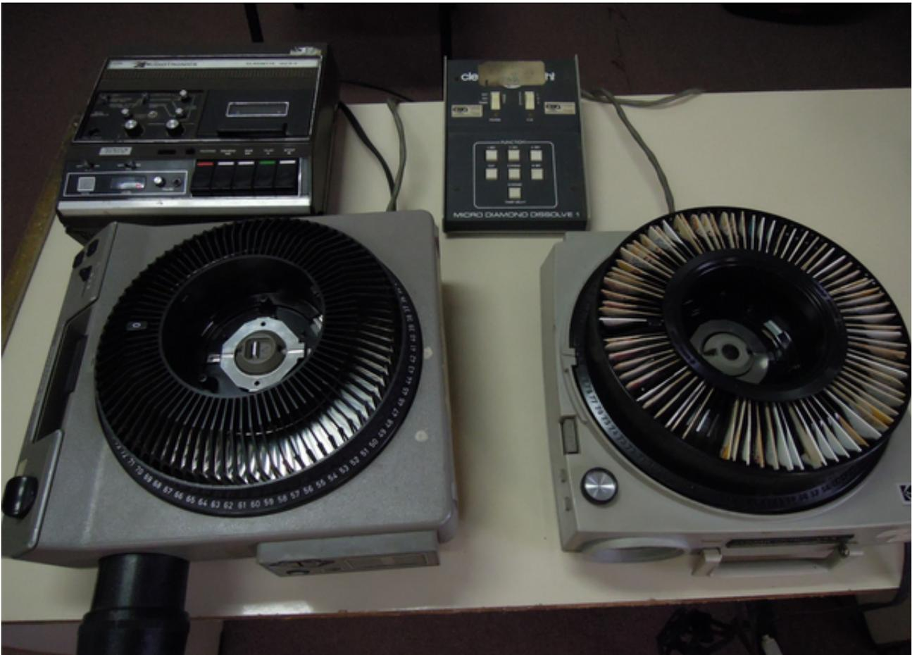
Figura 1: Equipos necesarios para la exhibición de un diaporramaje compuesto por dos proyectores, un casetero capaz de identificar la señal y combinar el pase de diapositivas y un mezclador.
